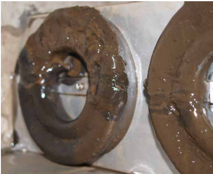
Nam châm lắp chèn trước khi vệ sinh
