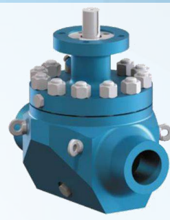
Van bi Top Entry Metal Seated K79 MSA dùng cho nhiệt độ cao Size: DN15 ~ DN1400 | Thân: Thép carbon/ Thép hợp kim/ Thép không gỉ Áp lực: CLASS 150 ~ 2500 | Nhiệt độ: -50°C ~ >550°C
