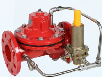
Van giảm áp tiêu chuẩn FM Kích thước: DN50 – DN250 | Nhiệt độ: 0°C to 87°C (32°F to 188°F) Thân: Gang | Áp lực max: 20.7bar (300 psi) | Nối bích PN16
