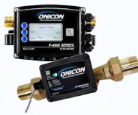
Thiết bị đo lưu lượng siêu âm dạng lắp đặt trực tiếp F-4600 Kích thước: 1/2" ~ 2 1/2" | Nhiệt độ làm việc: 32°F ~ 250°F Áp lực làm việc: 400psi | Độ chính xác: ±1.0%/2% Cấp bảo vệ: IP65
