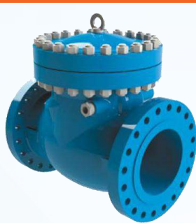
Van một chiều lá lật Swing Check Valve MSA Size: DN15 ~ DN1050 | Thân: Thép carbon/ Thép hợp kim/ Thép không gỉ Áp lực: PN16 ~ PN326 | Nhiệt độ: -50°C ~ >200°C
