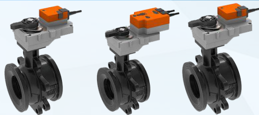
Van bi 2 ngã điều khiển bằng điện nổi bích Loại điều khiển thường hoặc Fail-Safe | Điều khiển On-Off/3 điểm/Tuyến Tính Thân: Gang | Áp lực: PN16 | Nhiệt độ: -5°C ~ 100°C
