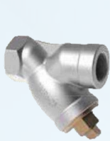
Y lọc bằng Gang nối ren/nối bích Size: DN20 ~ DN450 | Thân: Gang (GC200) Áp lực max: 1.0 MPa | Nhiệt độ: <80°C
