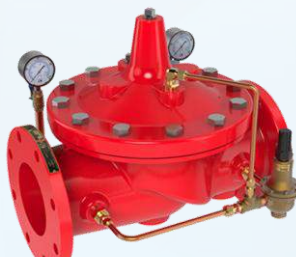
Van giảm áp tiêu chuẩn UL Kích thước: DN40 – DN300 | Nhiệt độ tối đa: 82°C (180°F) Thân: Gang | Áp lực max: 20.7bar (300 psi) | Nối bích PN16/Nối cùm/Nối ren
