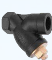
Y lọc bằng Gang nối ren/nối bích Size: DN15 ~ DN200 | Thân: Gang (GC200) Áp lực max: 1.0 MPa | Nhiệt độ: <220°C
