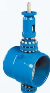
Van bướm điều khiển tuyến tính A49 Size: max DN800 Thân: Thép carbon/ Thép austenite Áp lực: 11.0 MPa Nhiệt độ max: +350°C
