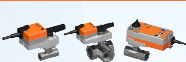
Van bi 2 ngã/3 ngã điều khiển bằng điện nổi ren Loại điều khiển thường hoặc Fail-Safe | Điều khiển On-Off/3 điểm/Tuyến Tính Thân: Đồng mạ Nickel | Áp lực: PN25/PN40 | Nhiệt độ: -10°C ~ 120°C
