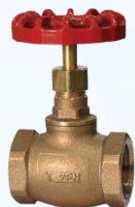
Van cầu bằng Đồng nối ren Size: DN15 ~ DN50 Thân: Đồng (Bronze) Áp lực: 300PSI Nhiệt độ: -10°C ~ 180°C
