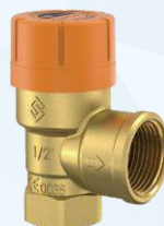
Van an toàn bằng Đồng nối ren Dùng cho hệ thống Năng lượng Mặt trời Áp lực max: 10Bar | Nhiệt độ: -30^{\circ}\text{C} \sim 120^{\circ}\text{C}
