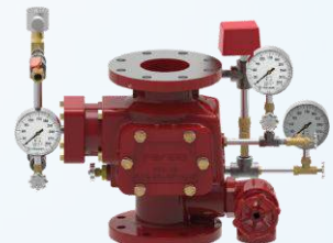
Van xả trần loại phản ứng nhanh KFI, UL, FM Product | Kích thước: DN100, DN150 Thân: Gang | Áp lực max: 175 PSI
