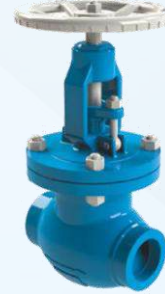
Van cầu nối bích/nối hàn Size: 50A ~ 600A Thân: Thép carbon/ Thép không gỉ/ Thép hợp kim Áp lực: Class 150 ~ 1500 Nhiệt độ max: +538°C
