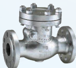
Van 1 chiều Thép nối bích Size: 50A ~ 300A Thân: Thép (SCPH2) Áp lực: 0.98MPa/1.96MPa Nhiệt độ max: 120°C/220°C
