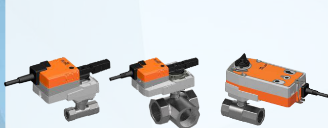
Van bi 2 ngã/3 ngã điều khiển bằng điện nổi ren Loại điều khiển thường hoặc Fail-Safe | Điều khiển On-Off/3 điểm/Tuyến Tính Thân: Đồng mạ Nickel | Áp lực: PN25/PN40 | Nhiệt độ: -10°C ~ 120°C
