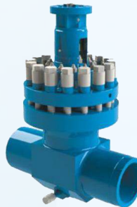
Van cổng cho điện hạt nhân A40 Size: DN50 ~ DN800 Thân: Thép carbon/ Thép austenite Áp lực max: 20MPa Nhiệt độ max: +350°C
