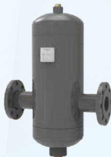
Lọc tách nước cho hệ hơi bằng Thép nối bích Kích thước: 15A ~ 200A | Thân: Thép (SPPS) Áp lực max: 2.0MPa | Nhiệt độ: <220°C
