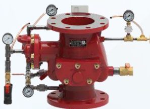
Van xả trần loại van khóa liên động nổi bích KFI Product | Kích thước: DN150 Thân: Gang | Áp lực max: 1.4 Mpa
