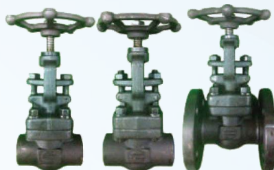
Van cầu Thép nối ren/nối bích/nối hàn Size: 15A ~ 50A Thân: Thép carbon Áp lực: 10K ~ 40K (optional) Nhiệt độ max: 450°C
