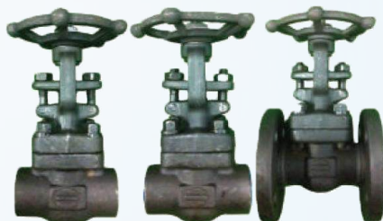
Van cổng Thép nối ren/nối bích/nối hàn Size: 15A ~ 50A Thân: Thép carbon Áp lực: 10K ~ 40K (optional) Nhiệt độ max: 450°C
