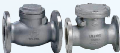
Van 1 chiều Inox nối bích Size: 15A ~ 300A Thân: Inox (SSC13) Áp lực: 0.98MPa Nhiệt độ max: 180°C
