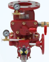
Van bảo động loại công tắc báo động nổi bích KFI Product | Kích thước: DN65 – DN150 Thân: Gang | Áp lực: 1.4 Mpa | Standard Type
