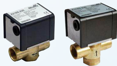
Van điều khiển cho Fan-coil/FCU Loại Fail-Safe | Điều khiển On-Off | Thân: Đồng Áp lực: 2100kPa | Nhiệt độ: 0°C ~ 93°C
