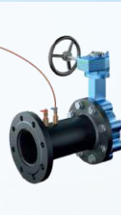
Van cân bằng chênh áp bằng Gang nối bích Kích thước: DN40 ~ DN250 | Thân: Gang Áp lực: PN16 | Nhiệt độ: -10°C ~ 120°C
