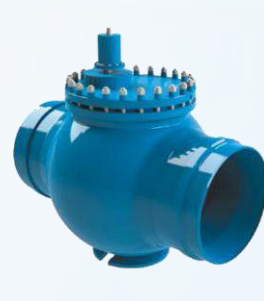
Van một chiều Swing check valve với thiết bị giám sát vị trí dùng từ xa Size: DN80 ~ DN500 Thân: Thép carbon Áp lực: 20 MPa Nhiệt độ max: +350°C
