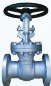
Van cổng Thép nối bích Size: 50A ~ 300A Thân: Thép (SCPH2) Áp lực: 0.98MPa/1.96MPa Nhiệt độ max: 120°C/220°C
