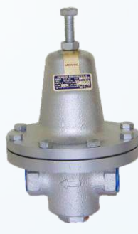
Van giảm áp bằng Gang nối ren Áp lực : 1.0MPa | Nhiệt độ: <220°C
