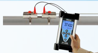
Thiết bị đo lưu lượng siêu âm kẹp ngoài cầm tay FP-4400 Kích thước: 1/2" ~ 48" | Nhiệt độ chất lỏng: -40°F ~ 300°F Phạm vi vận tốc: ±0.1 ~ 40 ft/s (±0.03 ~ 12.2 m/s) Độ chính xác: ±1.0% | Nguồn điện: Pin sạc (15 giờ) hoặc adapter AC (120-240 VAC) | Vỏ bảo vệ: IP67
