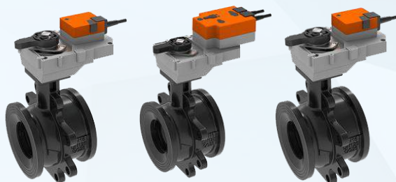
Van bi 2 ngã điều khiển bằng điện nổi bích Loại điều khiển thường hoặc Fail-Safe | Điều khiển On-Off/3 điểm/Tuyến Tính Thân: Gang | Áp lực: PN16 | Nhiệt độ: -5°C ~ 100°C
