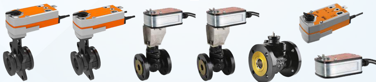
Van điều khiển bằng điện chuyên dụng cho hệ hơi | Hãng Belimo - Thụy Sĩ Loại Fail-Safe | Điều khiển On-Off/Tuyến Tính | Kích thước: DN15, DN25, DN40, DN50, DN65, DN80 Thân: Gang | Áp lực: PN16 | Nhiệt độ: 0°C ~ 175°C | Nối bích
