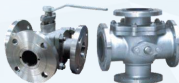
Van bi 3 ngã/4 ngã bằng Inox nối bích Size: 15A ~ 300A | Thân: Inox (SSC13) Áp lực: 0.98 MPa | Nhiệt độ max: 120°C
