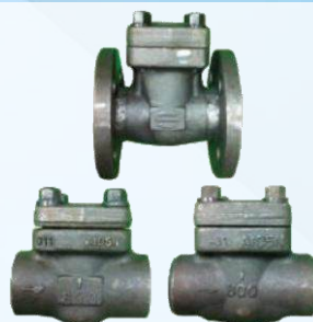
Van 1 chiều Thép nối ren/nối bích/nối hàn Size: 15A ~ 50A Thân: Thép carbon Áp lực: 10K ~ 40K (optional) Nhiệt độ max: 450°C
