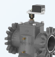
Van cân bằng kết hợp điều khiển điện nối bích Thân: Gang | Điều khiển tuyến tính/On-Off Áp lực: PN10/PN15/PN25/PN40 | Nhiệt độ: -20°C ~ 120°C
