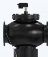
Van cân bằng kết hợp điều khiển điện nối bích Thân: Gang | Điều khiển tuyến tính/On-Off Áp lực: PN16/PN25 | Nhiệt độ: 5°C ~ 120°C
