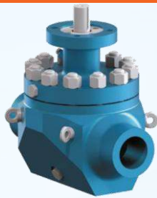
Van bi Top Entry Metal Seated K79 MSA dùng cho nhiệt độ cao Size: DN15 ~ DN1400 | Thân: Thép carbon/ Thép hợp kim/ Thép không gỉ Áp lực: PN16 ~ PN326 | Nhiệt độ: -50°C ~ >200°C
