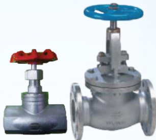
Van cầu Inox nối ren/nối bích Size: DN15 ~ DN300 Thân: Inox (SSC13) Áp lực: 0.98MPa/1.96 Mpa Nhiệt độ max: 180°C
