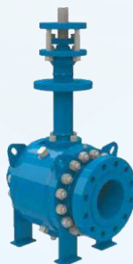
Van bi nhiệt độ âm từ 196 độ tới âm 50 độ K88 MSA Size: 50A ~ 300A Thân: Thép (SCPH2) Áp lực: 0.98MPa/1.96MPa Nhiệt độ max: 120°C/220°C
