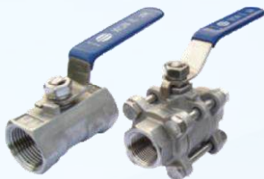
Van bi 1 mảnh/3 mảnh bằng Inox nối ren Size: 15A ~ 50A | Thân: Inox (SSC13/SSC14) Áp lực: 0.98MPa | Nhiệt độ max: 80°C
