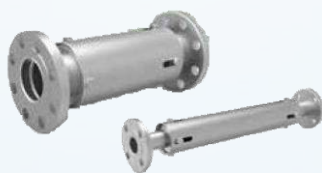
Khớp nối giãn nở Inox nối bích Size: DN25 ~ DN300 | Thân: Inox (STS) Áp lực max: 2.0 MPa | Nhiệt độ: <250°C
