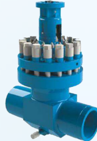
Van cổng cho điện hạt nhân A00 Size: DN50 – DN800 Thân: Thép carbon/ Thép austenite Áp lực max: 20Mpa Nhiệt độ max: +350°C
