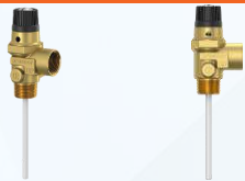
VAN AN TOÀN NHIỆT ÁP BẰNG ĐỒNG NỐI REN Áp lực max: 7Bar | Nhiệt độ: -10°C ~ 120°C
