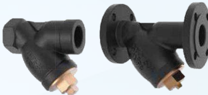
Y lọc bằng Gang nối ren/nối bích Size: DN15 ~ DN200 | Thân: Gang (GC200) Áp lực max: 1.0 MPa | Nhiệt độ: <220°C
