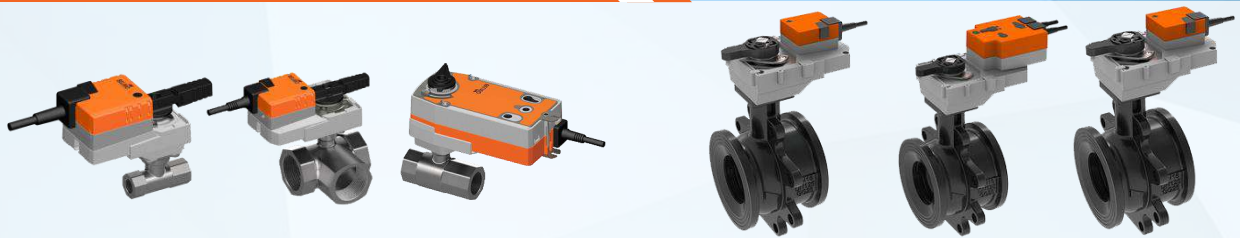
Van bi 2 ngã/3 ngã điều khiển bằng điện nổi ren Loại điều khiển thường hoặc Fail-Safe | Điều khiển On-Off/3 điểm/Tuyến Tính Thân: Đồng mạ Nickel | Áp lực: PN25/PN40 | Nhiệt độ: -10°C ~ 120°C
