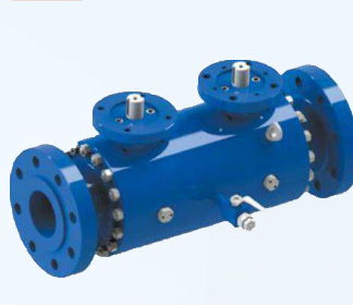
Van chặn và van xả đôi Double Block and Bleed Valves Size: DN15 – DN1400 | Thân: Thép carbon/ Thép hợp kim/ Thép không gỉ Áp lực: PN16 – PN326 | Nhiệt độ: -50°C – >200°C
