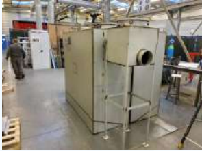
Máy tách mỡ tự động, dùng vòi xả cao áp, bộ điều khiển, van điện tử và bơm tự động. Chất liệu Inox
