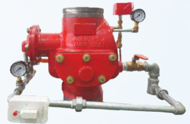
Van xả tràn loại phản ứng nhanh nổi cùm KFI Product | Kích thước: DN80 ~ DN150 Thân: Gang | Áp lực max: 1.4 Mpa/2.2 Mpa
