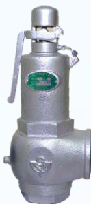
Van an toàn bằng Gang nối ren Áp lực : 1.0MPa | Nhiệt độ: <220°C
