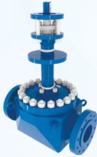
Van bi nhiệt độ âm và dương cao Top-entry cryogenic ball valve K78 MSA Size: DN15 – DN500 | Thân: Thép carbon/ Thép hợp kim/ Thép không gỉ Áp lực: PN16 – PN326 | Nhiệt độ: -50°C – >200°C
