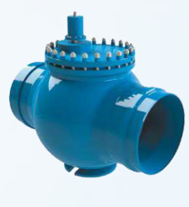
Van một chiều Swing check valve với thiết bị giảm sét vị trí đứng tử xả Size: DN80 – DN600 Thân: Thép carbon Áp lực: 20 MPa Nhiệt độ max: +350°C
