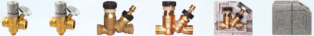
VAN CÂN BẰNG NHIỆT ĐỘ CHO CÁC HỆ THỐNG TUẦN HOÀN NƯỚC NÓNG Thân: Đồng | Áp lực: PN10/PN16 | Nhiệt độ đầu vào max: 90°C | Dải nhiệt độ điều chỉnh: 40°C ~ 65°C
