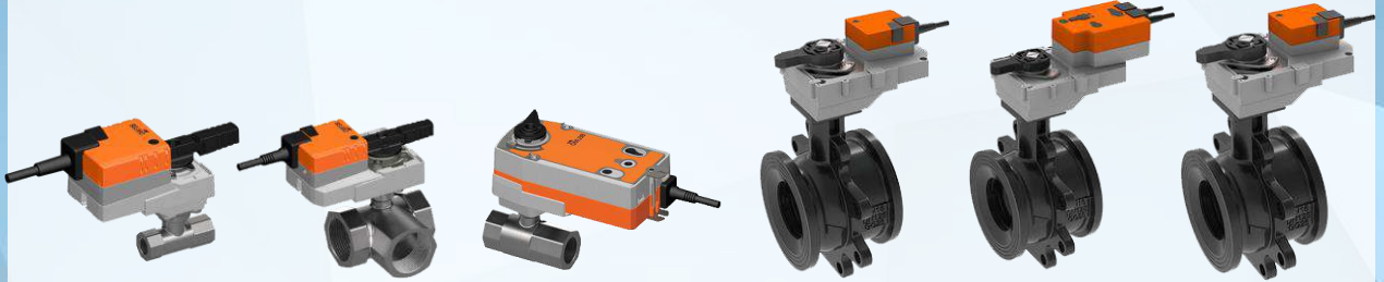
Van bi 2 ngã/3 ngã điều khiển bằng điện nổi ren Loại điều khiển thường hoặc Fail-Safe | Điều khiển On-Off/3 điểm/Tuyến Tính Thân: Đồng mạ Nickel | Áp lực: PN25/PN40 | Nhiệt độ: -10°C ~ 120°C
