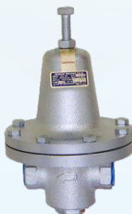
Van giảm áp bằng Gang nối ren Áp lực : 1.0MPa | Nhiệt độ: <220°C
