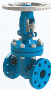
Van cổng nổi bích/nổi hàn Size: 50A – 1200A Thân: Thép carbon/ Thép không gỉ/ Thép hợp kim Áp lực: PN16 – PN100 Nhiệt độ max: +538°C
