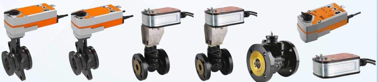
Van điều khiển bằng điện chuyên dụng cho hệ hơi | Hãng Belimo - Thụy Sĩ Loại Fail-Safe | Điều khiển On-Off/Tuyến Tính | Kích thước: DN15, DN25, DN40, DN50, DN65, DN80 Thân: Gang | Áp lực: PN16 | Nhiệt độ: 0°C ~ 175°C | Nổi bích
