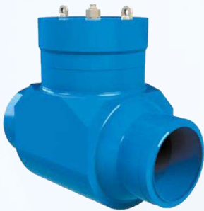
Van 1 chiều lá lật với vòng đệm chịu áp lực cao Size: DN100 – DN300 | Thân: Thép carbon/ Thép austenite Áp lực max: 20Mpa | Nhiệt độ: -50°C – +350°C
