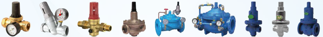
VAN GIẢM ÁP CHO CÁC HỆ THỐNG NƯỚC Thân: Đồng/Inox/Gang | Nối Bích/Nối ren | Áp lực: PN10/PN16/PN25 | Nhiệt độ làm việc max: 80°C
