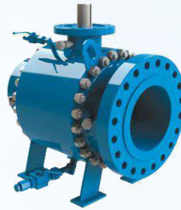
Van Bi Seat bằng kim loại K89 MSA Nổi hàn/nổi bích Size: DN15 – DN1400 | Thân: Thép carbon/ Thép hợp kim/ Thép không gỉ Áp lực: Class 150 - 2500 | Nhiệt độ: -50°C – >550°C
