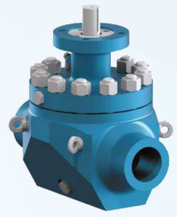
Van bi Top Entry Metal Sealed K79 MSA dùng cho nhiệt độ cao Size: DN15 – DN1400 | Thân: Thép carbon/ Thép hợp kim/ Thép không gỉ Áp lực: CLASS 150 - 2500 | Nhiệt độ: -50°C – >550°C
