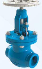
Van cổng nổi bích/nổi hàn Size: 50A – 600A Thân: Thép carbon/ Thép không gỉ/ Thép hợp kim Áp lực: Class 150 - 1500 Nhiệt độ max: +538°C
