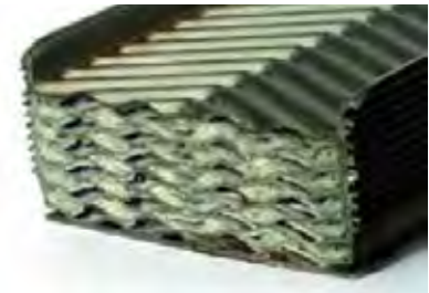
Bộ trao đổi nhiệt dạng tấm sau 6 tháng vận hành: phần lớn các đường dẫn bị vôi hóa – cần phải vệ sinh kỹ lưỡng.
